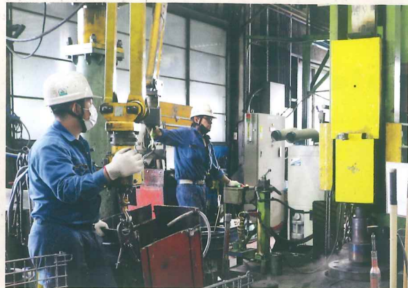
板で巻き上げたおもり(金錠)を一気に落として形を造る「ボードロップハンマー」。同社員の平均年齢は36歳と若い
