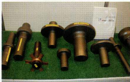
ミヤジマで鍛造されたシャフトの数々。汎用的な金型の組み合わせによって、多彩な部品に対応できる。
