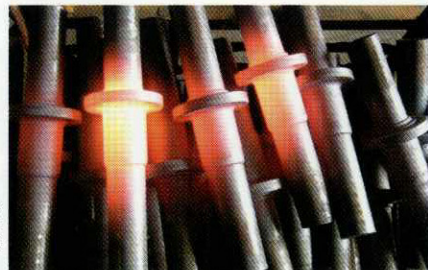
鍛造においては、強度を維持するための温度管理が極めて重要となる。
